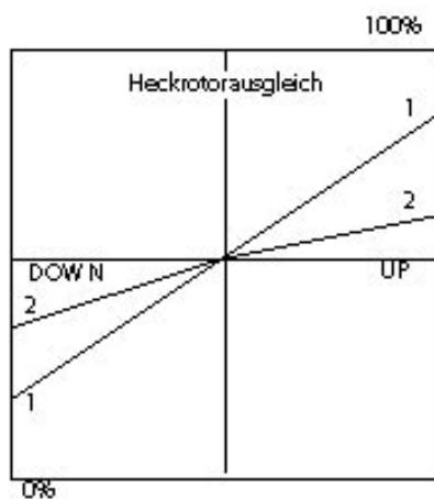
Um die Heckrotorwirkung für den unteren Pitchbereich einzustellen, muß das Modell in angemessener Sicherheitshöhe schweben.
